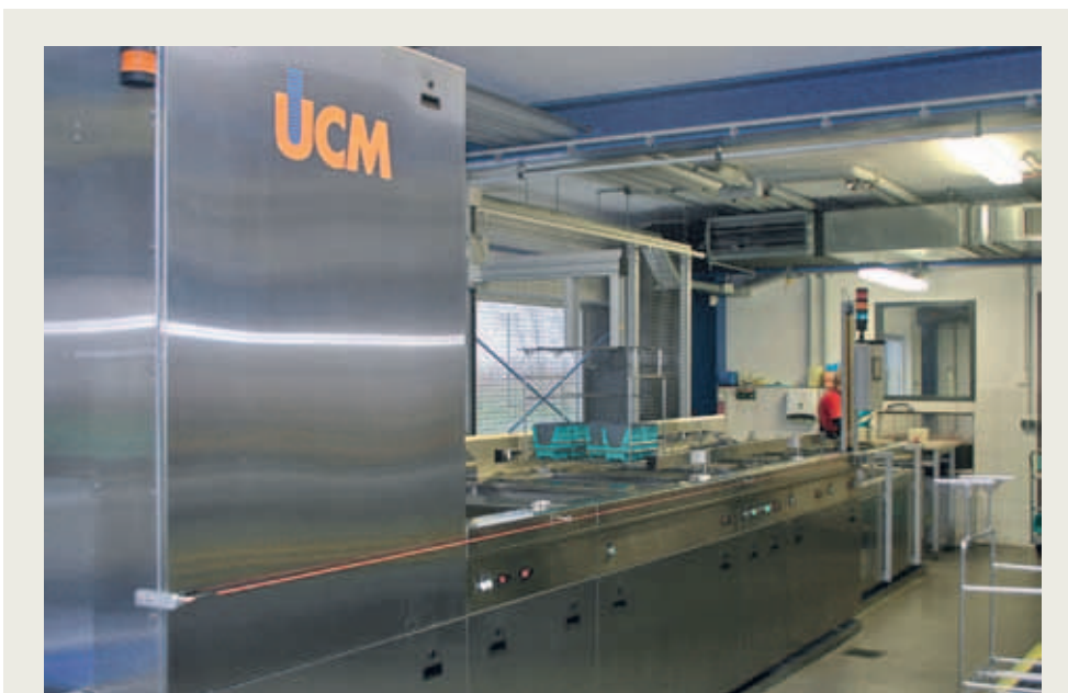
▲ Die Silicium-Wafer durchlaufen in der Ultraschallreinigungsanlage fünf Becken
